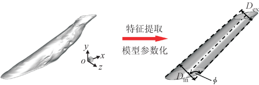
图 5 锥形喷嘴气膜孔缺陷参数化模型示意图 [16] Fig. 5 Conical nozzle film hole imperfection model [16]
